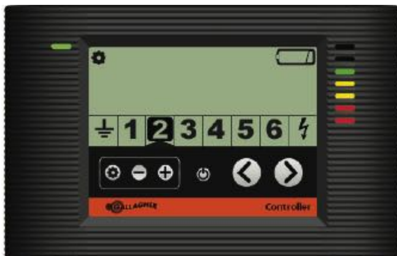
Controlador mostrando la zona 2 con batería baja
